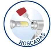
Recomendado para vedação de tubulações metálicas cônicas e conexões hidráulicas e pneumáticas até 2". Vedante químico anaeróbico, de alta viscosidade e baixa resistência à desmontagem, uma vez aplicado evita corrosão e impede vazamentos entre as conexões metálicas. Após a cura resiste a água, óleo e solventes.
