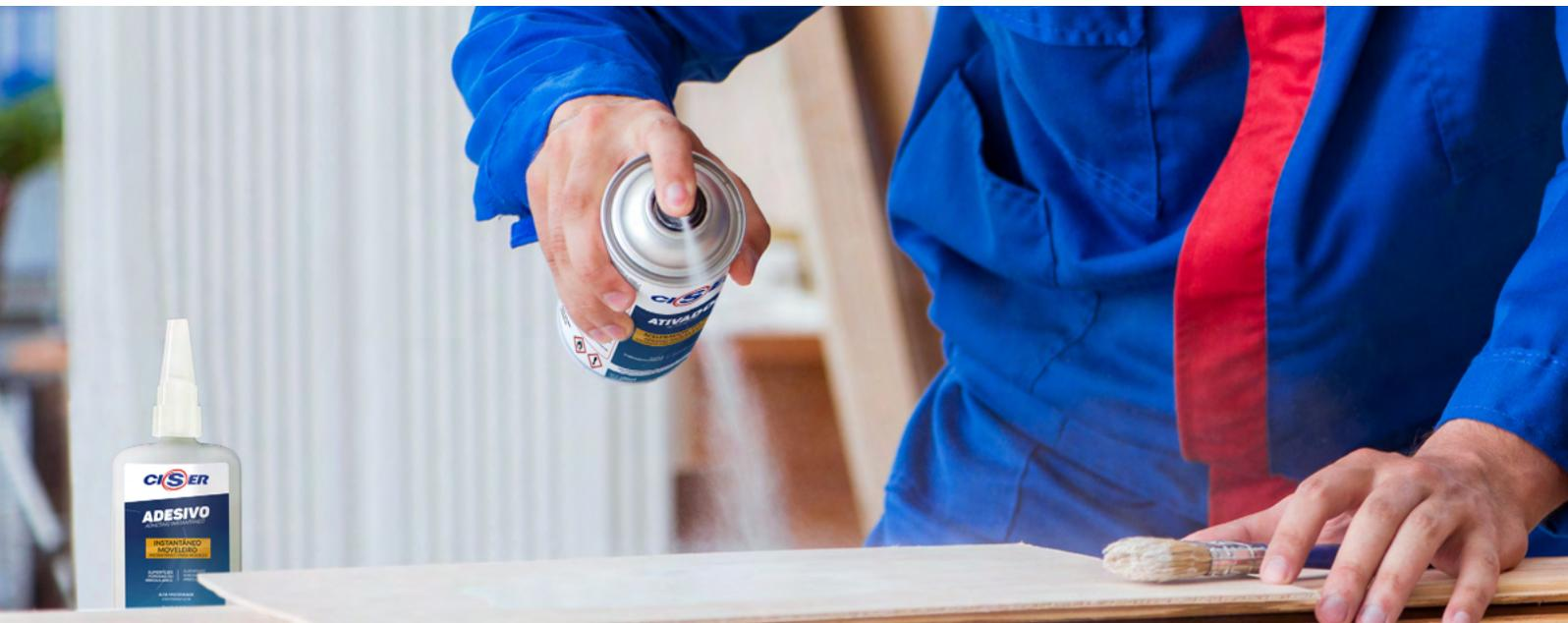
Adesivo a base de cianoacrilato é um produto monocomponente e não requer mistura, seu processo de cura inicia quando uma fina camada do produto é aplicada entre as superfícies entrando em contato com a umidade do ar. O acelerador é um produto monocomponente à base de solvente, destinado a acelerar a cura de adesivos à base de cianoacrilato, garantindo maior adesão e ligação instantânea.
